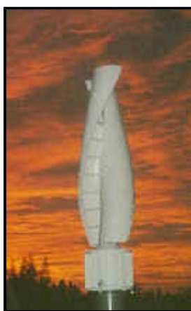
Turbina uporovnega tipa vrste Windside. (Windside)
